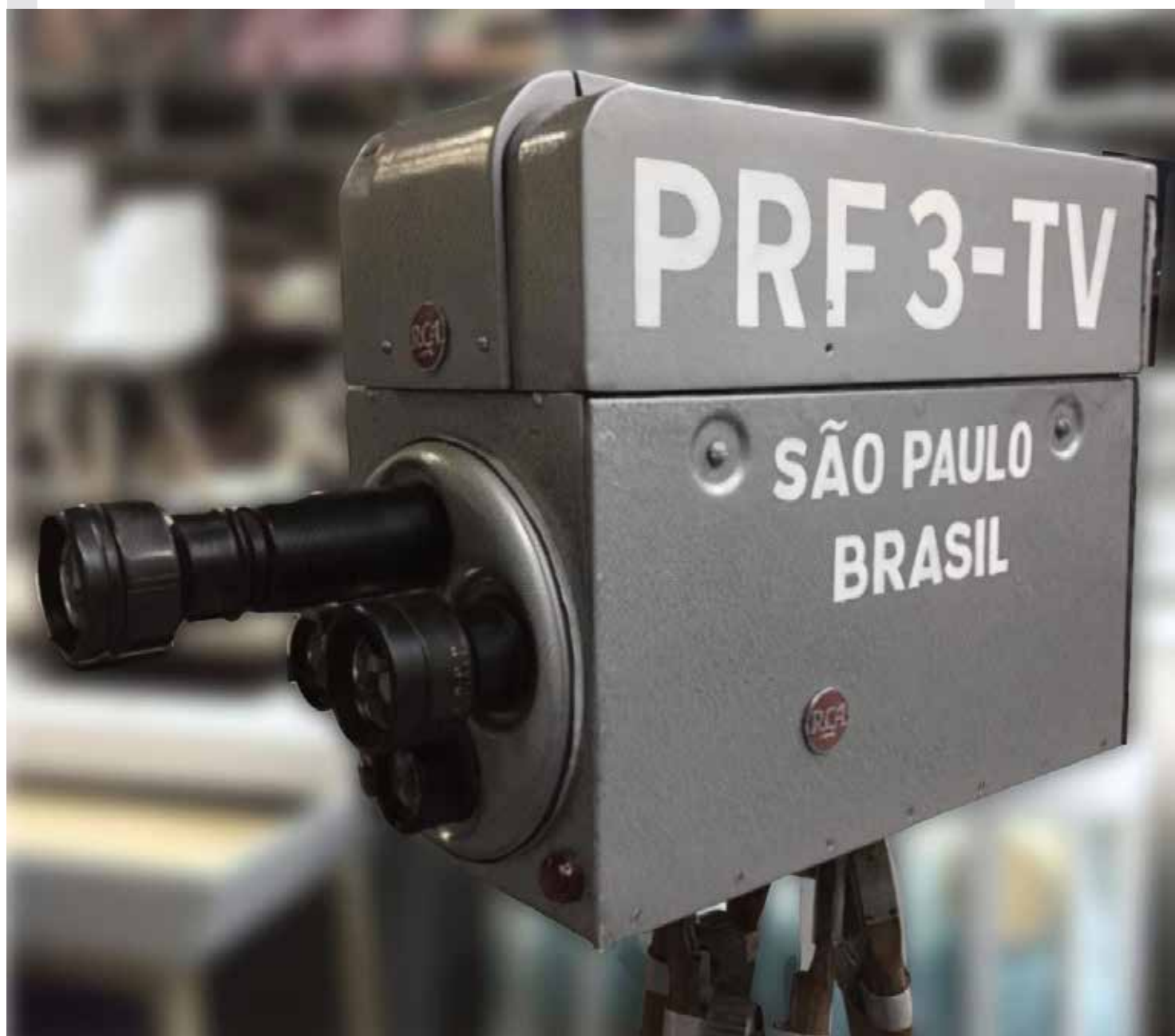
Câmera recuperada, modelo RCA TK-30, que outrora pertenceu à TV Tupi de São Paulo (reprodução).
